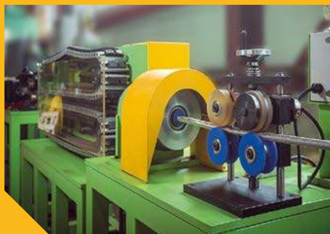
Процесс гофрирования трубы
